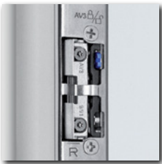
Stikalo za dnevno/nočni režim integriran v prijemnik na podboju (začasno blokira delovanje magnetnega sprožilca)
