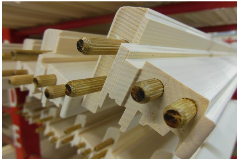
Mozniki vstavljeni pred spajanjem okenskih elementov in površinsko povsem zaščiten okenski element
