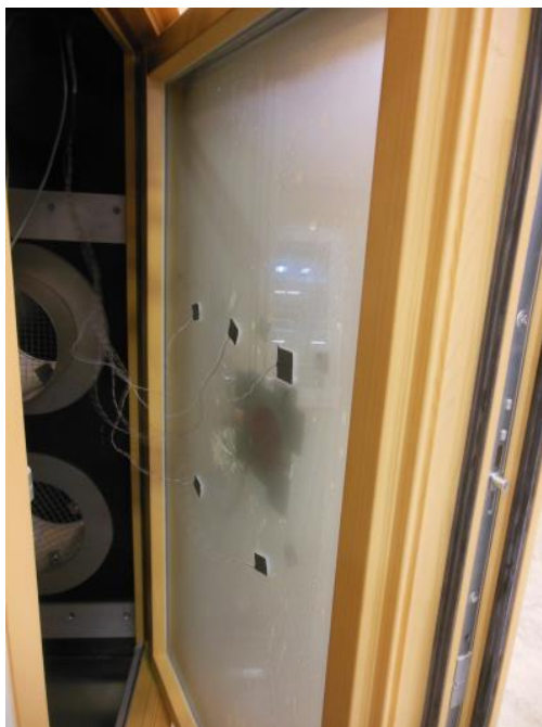
Nastanek kondenza na površini stekla na zunanji strani okna
