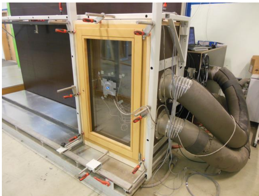
Okno s troslojno zasteklitvijo med testom vpeto v testno steno
