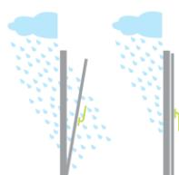
Odprta okna (vrata) po vertikalni ali horizontalni osi ne izpolnjujejo zahtev o vodotesnosti, zvočni in toplotni izolaciji ter zaščiti proti vlotom.
