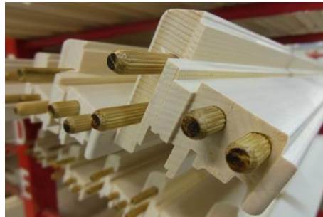
Abb. 65: Dübelverbindung der Fenster von M SORA
