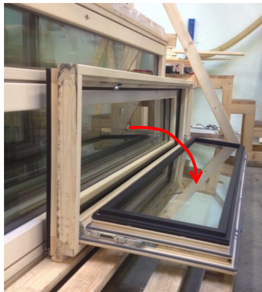
Image 51: Position finale - le battant de fenêtre doit être maintenu
