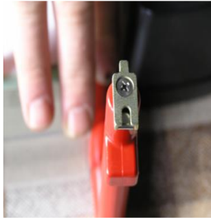
Image 31: Clé pour détacher les battants de la fenêtre
